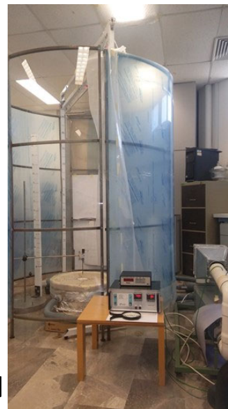
ΘΑΛΑΜΟΣ ΔΙΑΧΥΣΗΣ ΘΕΡΜΟΤΗΤΑΣ ΚΑΙ ΡΥΠΩΝ
